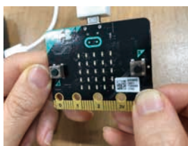
● micro:bit の端子にタッチする様子 (右端の GND 端子をつまみ、0 または 1 または 2 の端子にふれます)
