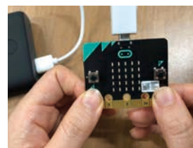
● micro:bit の端子にタッチする様子 (右端の GND 端子をつまみ、0 または 1 または 2 の端子にふれます)
