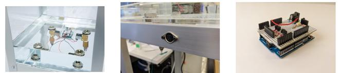
図 6 左: Potarhythm を上から見た図 中央: MIDI 差込口 右: MIDI 通信とソレノイドバルブの制御を行うデバイス
