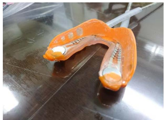
図 7 スポーツ用マウスピースの改造（センサ貼りつけ・歯型成形前）
