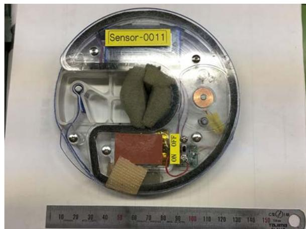
図2 車載中継器
