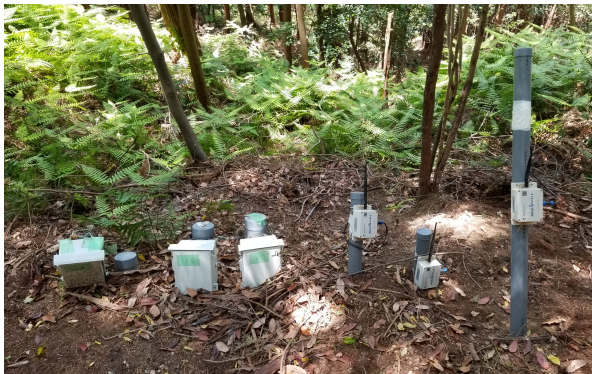
図-8 調査地 A の設置写真 (左 : IoT デバイス A、右 : IoT デバイス B)
