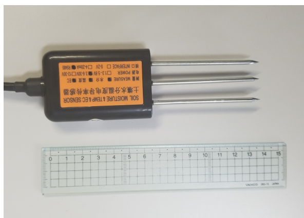
図-3 IoT デバイス B の土壌水分センサ
