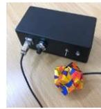
図 1 加速度センサー(自作)
