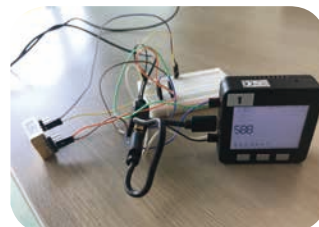
M5Stack でつくった CO 2 計測器
