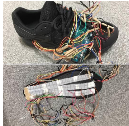
図2 インソール型歩容センサ (センサ数 32)
