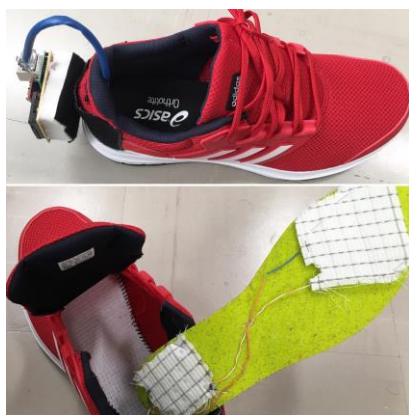
図 4 インソール型歩容センサ（センサ数 2）
