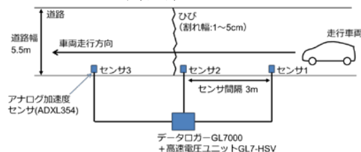
図 1 本実験における測定系
