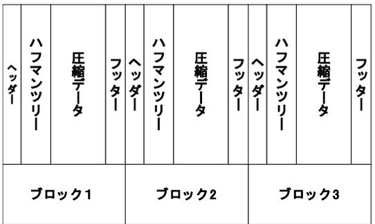
図 3 Deflate 圧縮を用いた際の圧縮ファイルの内部構造
