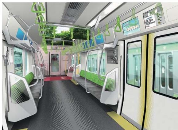
図3 最新通勤車両の網棚上のサイネージ
