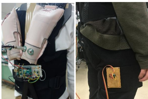
図 11 加速度センサの取り付け位置
