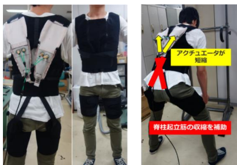
図6 腰部補助用アシストウェア(試作機)
