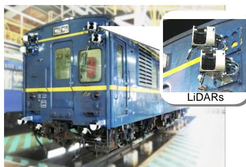
図 2 LiDAR を用いた建築限界車上検測システム
