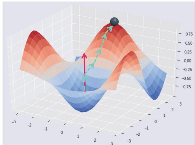
図 6 摂動フィルタ幅の更新方法の違いによる勾配の向き
