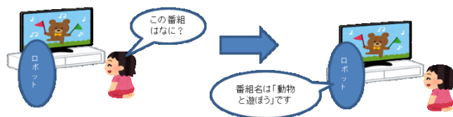
図 1-2 テレビに関することについて人がたずねると答えてくれるロボット (受動型ロボット)
