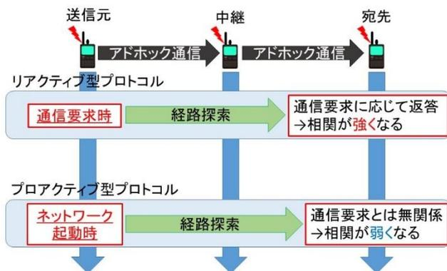
図2 プロトコルによる経路探索の差異
