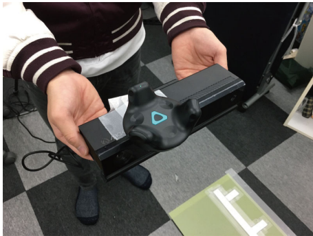
図 2 移動カメラに取り付けられたマーカ
