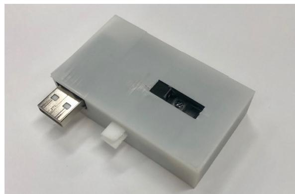
図 3 タブレットの動きを読み取る装置
