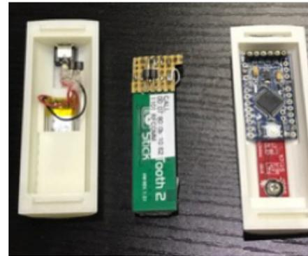
図 3 動作計測モジュールの内部
