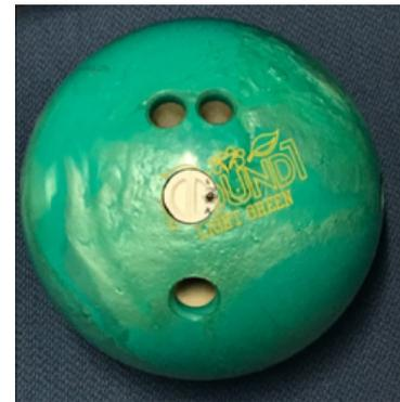
図 4 モジュールを挿入したボール
