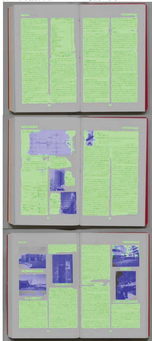
図3 『科学技術文献サービス』に対して自動認識を行った結果(緑が文字領域、青が挿絵領域)
