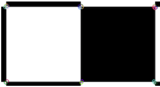
図2 OpenCV がそなえる FAST コーナー検出器によるコーナー検出結果
