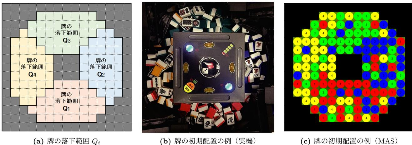
図 3 ドラム空間における牌の落下範囲  $Q_i$  および牌の初期配置の例
