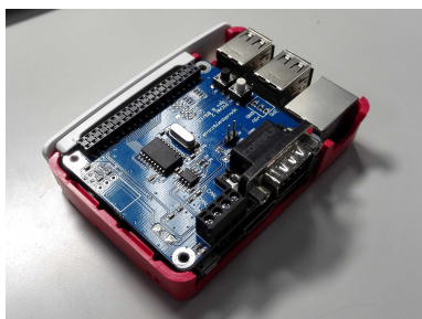
図 2 実験に使用した装置 (Raspberry Pi 3 + PiCAN 2)
