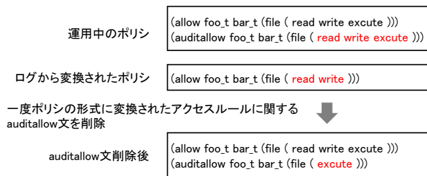
図 5 一度ポリシーの形式に変換されたアクセスルールに関する auditallow 文をポリシーから削除する例
