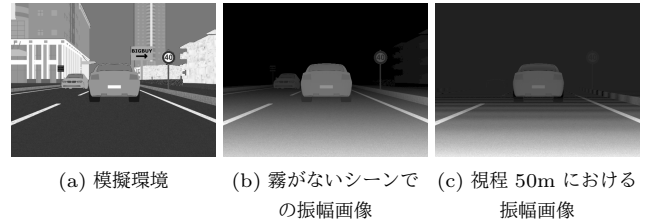
図 8 (a) 作成した模擬環境。(b) 霧がないシーンにおいて計測した時の振幅画像と (c) 霧があるシーンにおいて計測した時の振幅画像。(c) のような霧があるシーンの計測値から正しい距離の推定を行う。
