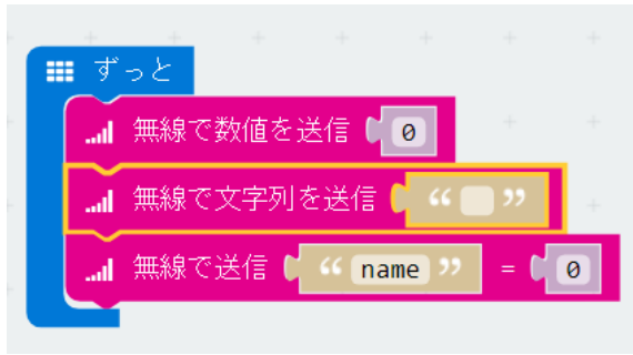
図 5: micro:bit の「無線で送信」ブロックを使ったプログラム例
