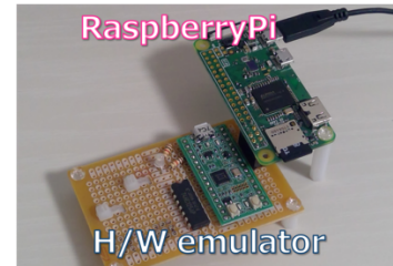
図 4 (左) H/W エミュレータおよび (右) ビジュアルプログラミング部が駆動する RaspberryPi Figure 4 (Left) H/W emulator and (right) Raspberry Pi Zero W, which runs the visual programming element.
