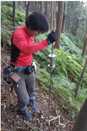
図 6 簡易貫入試験の様子
