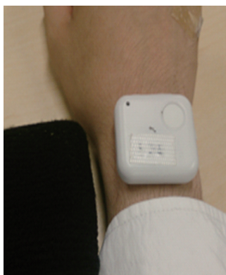
図 1 3 軸加速度・角速度センサの装着場所
