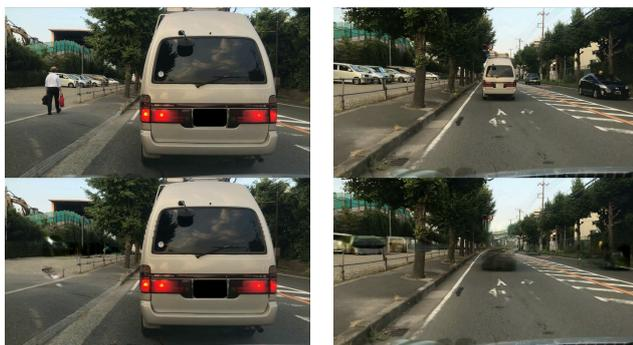
図 7 (左: 検出不可例) 物体との距離が極端に近いために大きく映り過ぎることで検出失敗している. (右: 荒い再構成結果の例) 中央の車のような大きな物体の除去は, 左や左奥の小さな物体の除去に比べ, 再構成結果が荒い. (上段: 入力, 下段: 出力)
