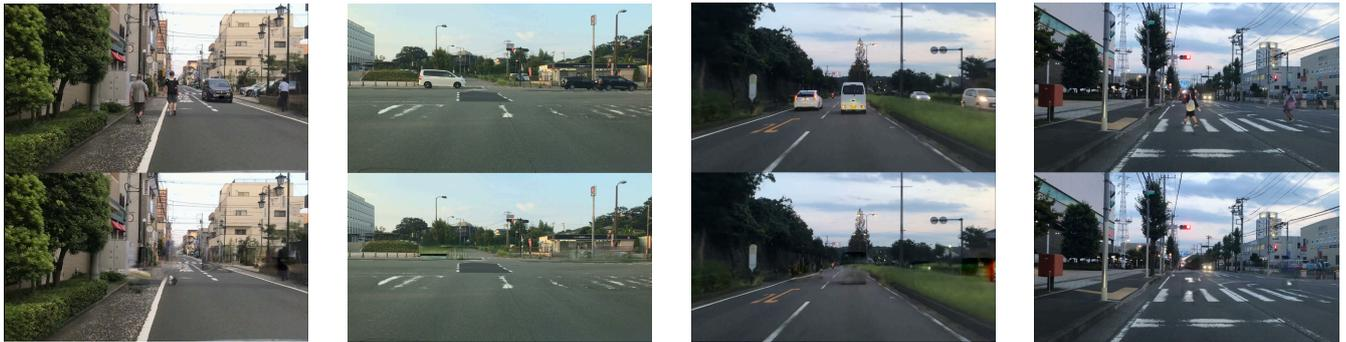
図 4 GANonymizer でプライバシー情報を除去した結果 (左二つ) 日中に撮影した画像と (右二つ) 夕暮れ時に撮影した画像に対して適用. (上段) 入力画像と (下段) 出力画像.
