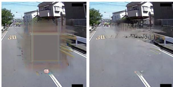
図 6 2段階生成処理の効果: (左) 通常の再構成結果と (右) 2段階生成処理を適用した場合の再構成結果
