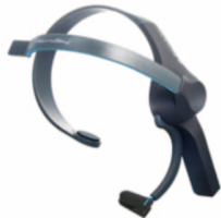
図3 脳波センサ:Mind wave-mobile(Neuro Sky 社)
