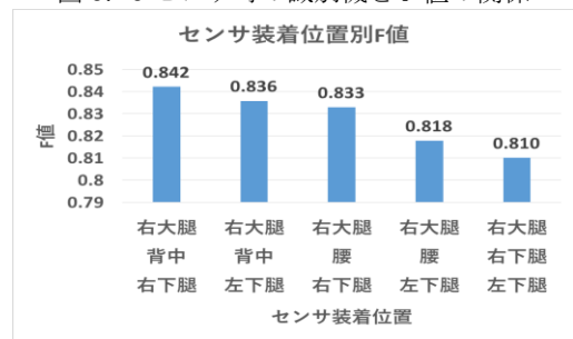
図 4. 3 センサ使用・RF 認識器使用時の装着位置別 F 値
