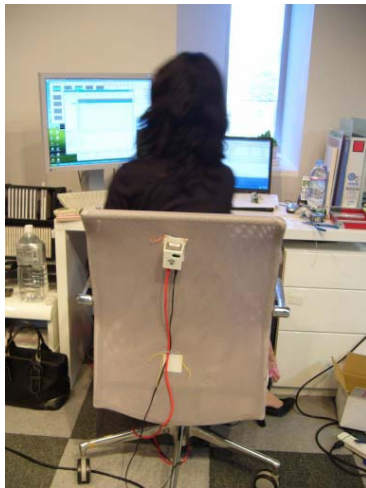
図2 イスに添付されたセンサノード
