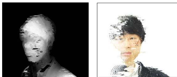
(a)視差マップ (b)正面顔変換画像 図 2 顔の視差マップと正面顔変換画像
