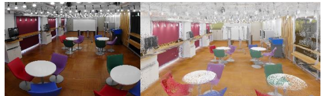
図2 実際の部屋と点群データの比較
