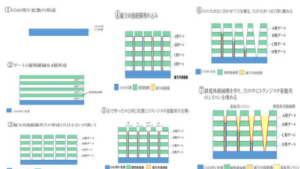
図5 低抵抗ポリシリコンによる縦方向接続方式の製造プロセス
