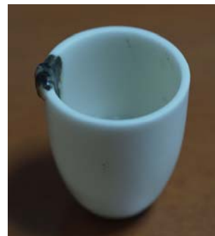
図5 坩堝に溶着したガラス蛍光体（黒色部分）
