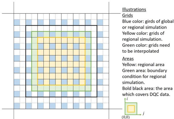
Fig. 6 Interpolation process in DQC.
