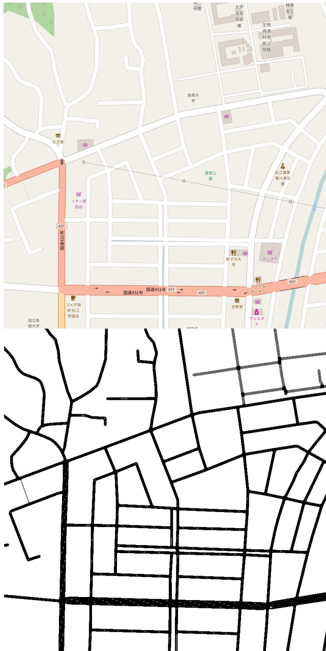
図 1 OpenStreetMap 地図と変換した SUMO ネットワーク Fig. 1 OpenStreetMap map and converted SUMO network
