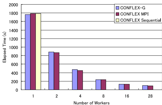
図 8 Dennis クラスタにおいてサンプル分子 AlaX04 を CONFLEX-G と MPI 版 CONFLEX で配座探索した実行時間
