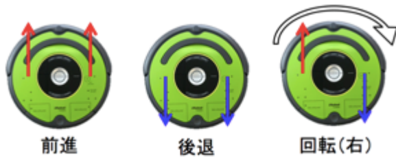
図 4 iRobot Create2 の前進・後退・回転
