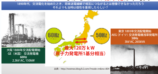
図-3 日本における電源周波数による電力網の分断
