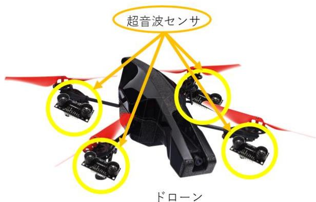
図2 超音波センサの配置図
