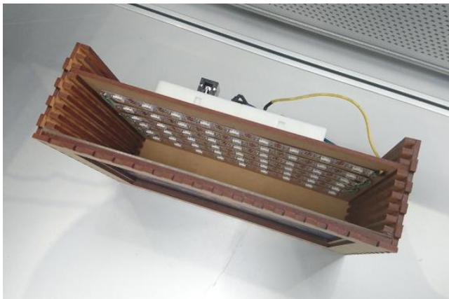
図5 筐体内部の構造。複数の溝を設け、紙媒体やフィルターの位置を調整できる。
