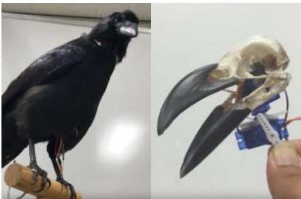
図 8 カラスと対話する装置(地上型) Figure 8 Dummy talker for crow (ground system)
