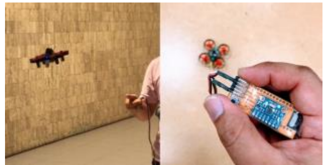
図 9 ハンドジェスチャー操作ドローン Figure 9 Gesture controlled toy drone
