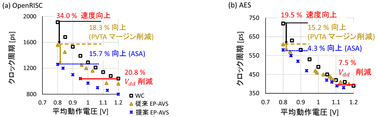
図7 クロック周期と電源電圧のトレードオフ曲線. (a) OpenRISC, (b) AES.
