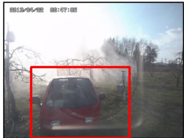
図3 テンプレートマッチングによる農業用機械の抽出結果
