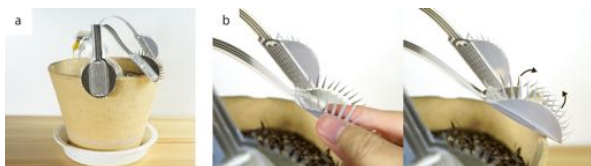
図6 ハエトリソウの動作の様子。a: 全体図。b: アプリケーションの動作の様子。タッチパッドを指で触れることによって電熱線が駆動し、葉が閉じる。
