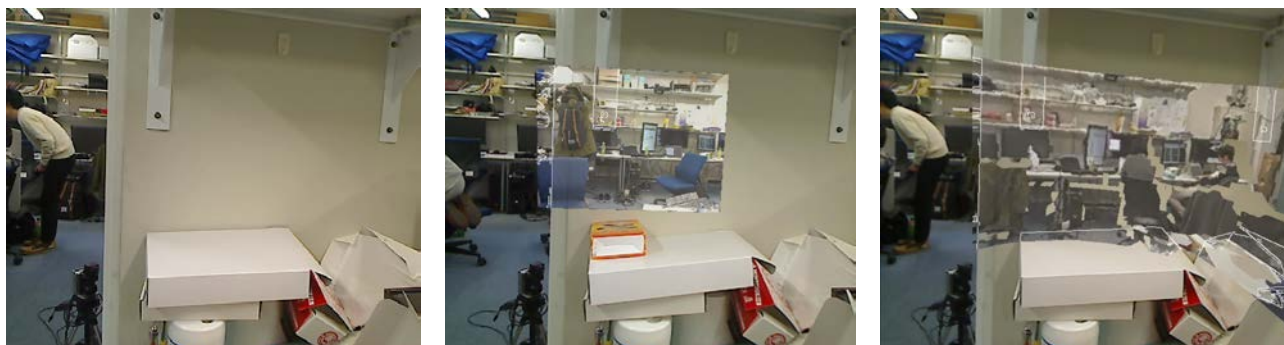
図3 DR 処理結果比較 (左から DR 処理前, 射影変換+RGB カメラ, 提案手法)
