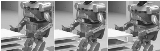
図 20 パネル把持 Fig. 20 Grasping of a panel.
