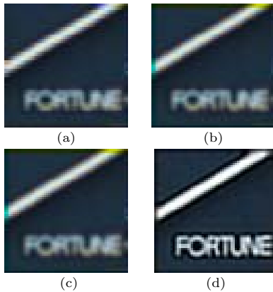
図 8 復元画像 . (a) 最近傍点補間 (複数画像) . (b) 線形補間 (複数画像) . (c) キュービック補間 (複数画像) . (d) 提案手法, f = 2, M = 8
